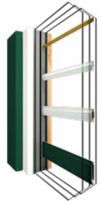
Sprossen im Scheibenzwischenraum 8 mm, 18 mm, 26 mm und 45 mm
